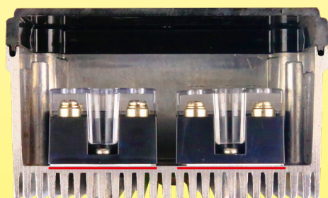
Ejemplo de instalación de relés de estado sólido en una carcasa de aluminio de Ultimheat (compuestro térmico en rojo).
